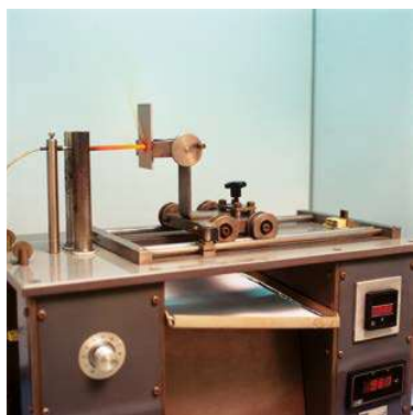
Ensayo del hilo incandescente a 960°C s/EN 61537.
