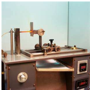
Ensayo del hilo incandescente a 960°C s/EN 61537.
